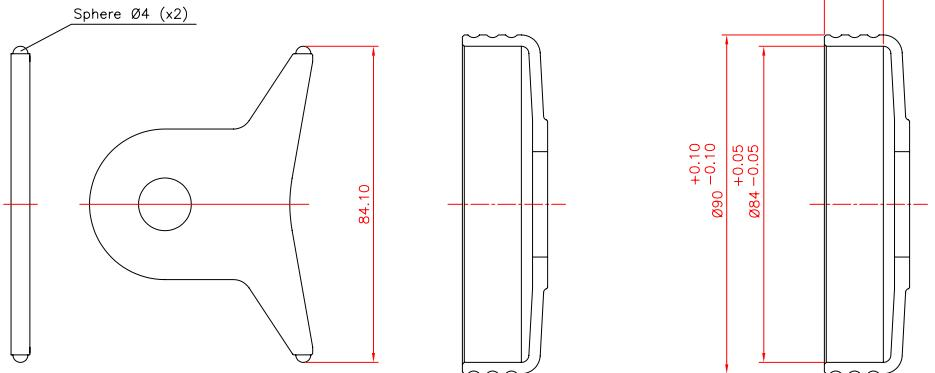
**Toute la surface du matériau de friction du rotor de l'embrayage doit toujours travailler à l'intérieur de la surface de la piste de 15,5 mm de la cloche.**
